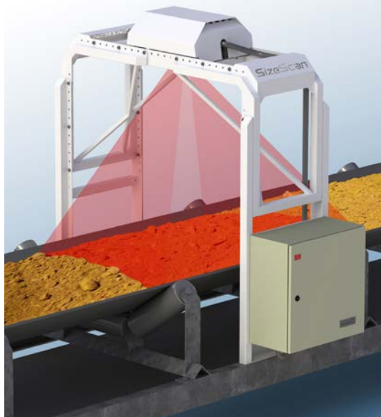
SizeScan в работе с невидимым потоком ИК-лучей, показанным красным цветом. (Примечание: Лазерная продукция 1 класса безопасности)
