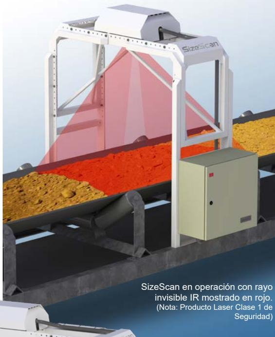
SizeScan en operación con rayo invisible IR mostrado en rojo. (Nota: Producto Laser Clase 1 de Seguridad)
